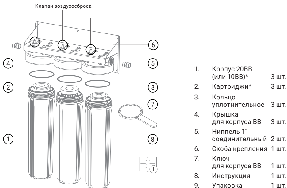
Рис. 1. Пример комплектации фильтра Гейзер МАКС ВВ с корпусами 20ВВ**.
