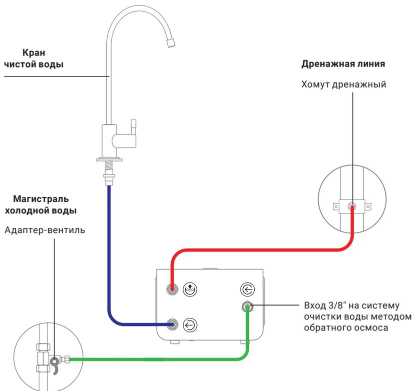
Рис. 2. Схема подключения.
