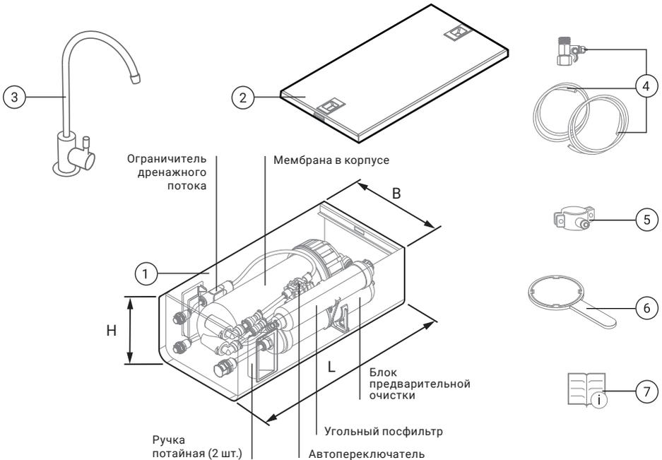
Рис. 1. Внешний вид, комплектация и габаритные размеры фильтра <sup>[1]</sup>.
