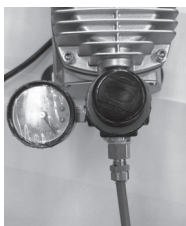
Рис.5. Подключение компрессора AP-2 к азрационной колонне
