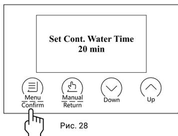
E. Установка пикового расхода до закрытия подачи воды.
